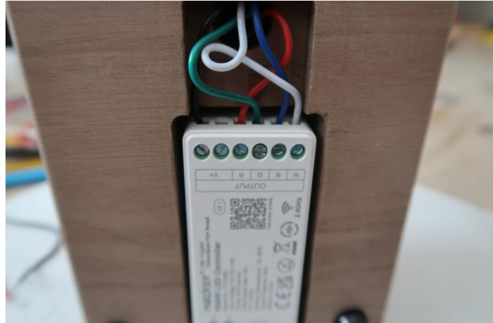
Mein Controller wird mit 24 Volt betrieben. Dazu müsst ihr also noch ein passende Netzteil kaufen. Für die Länge von 1Meter Led-Streifen langt ein Netzteil mit 1,5A und 36 Watt
